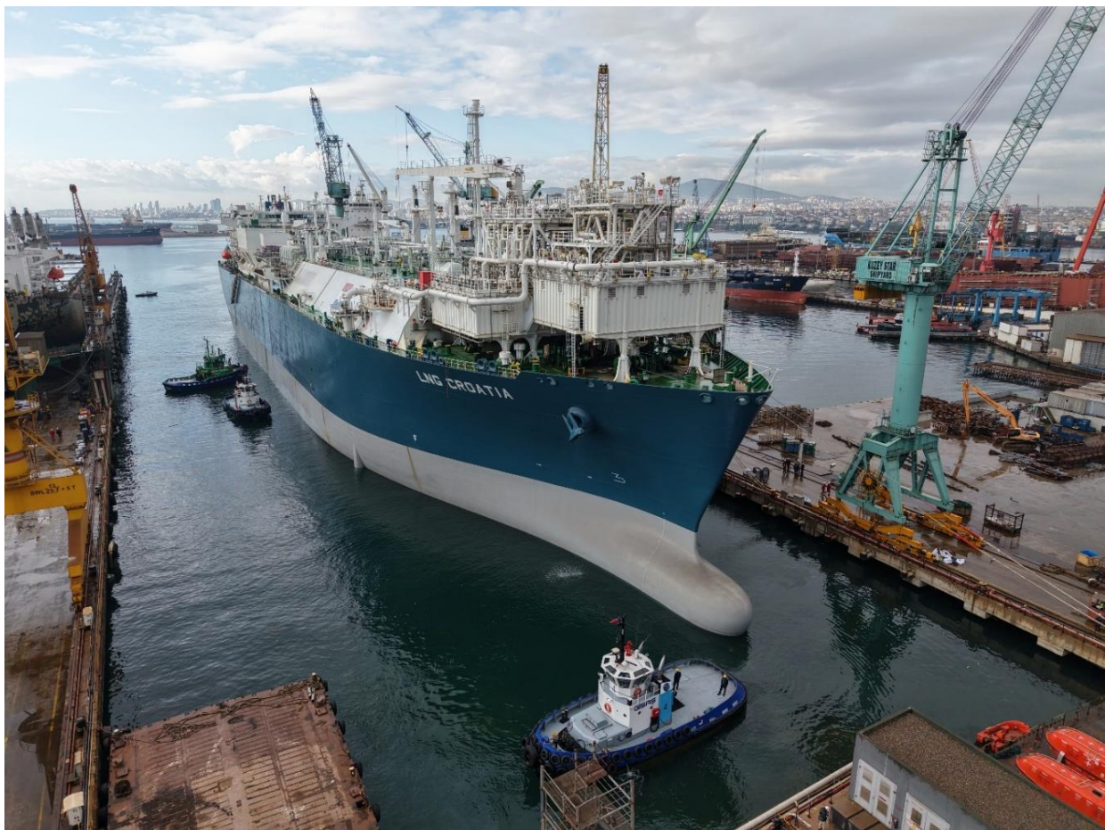
Slika 8. FSRU brod u turskom brodogradilištu Kuzey Star nakon ugradnje dodatnog modula
