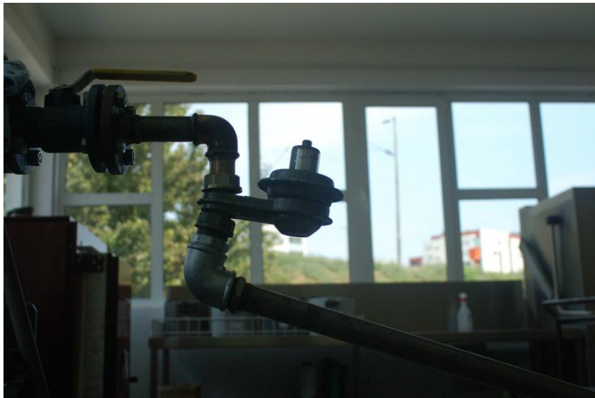
Slika 6d. Regulator tlaka 2. tipa podvrgnut momentu savijanja od 97 Nm
