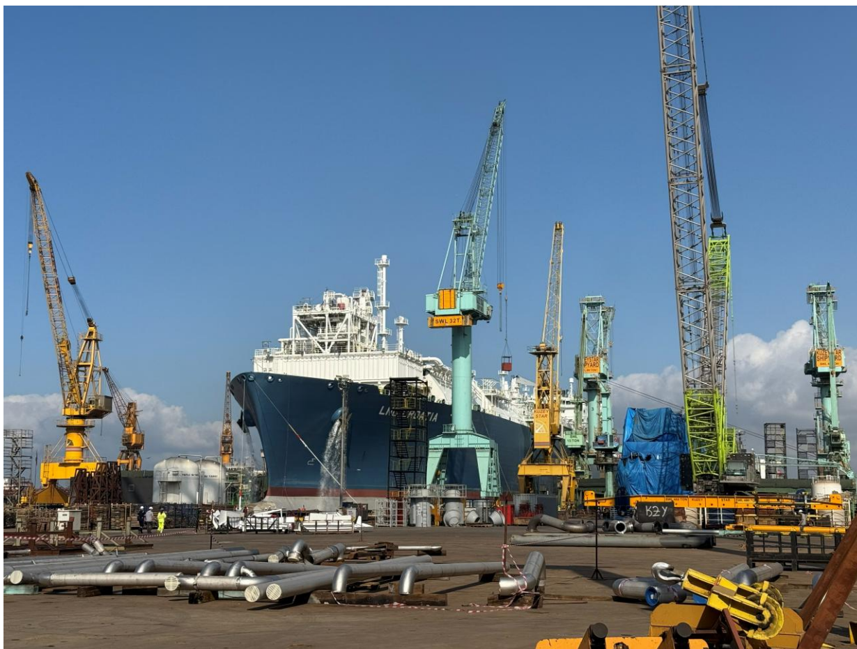
Slika 3. Dio predfabriciranih elemenata spreman za ugradnju
