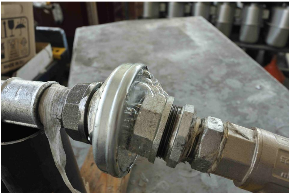
Slika 6f. Regulator tlaka 2. tipa podvrgnut momentu savijanja od 109 Nm
