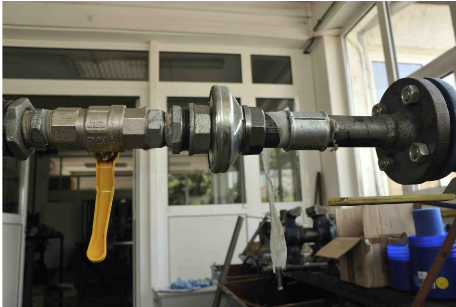
Slika 6e. Regulator tlaka 3. tipa podvrgnut momentu savijanja od 40 Nm
