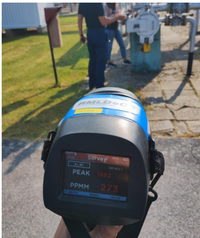
Slika 3. Detekcija propuštanja laserskim detektorom metana
