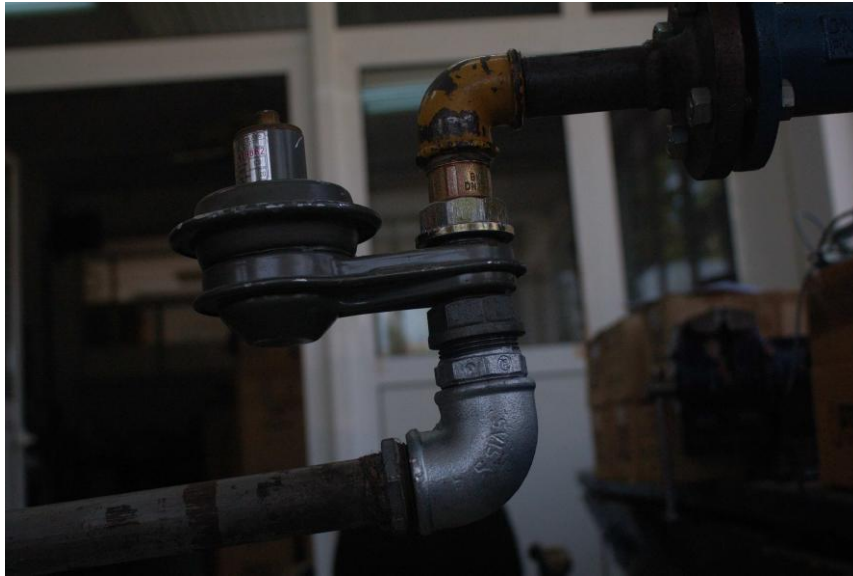
Slika 6c. Regulator tlaka 2. tipa podvrgnut momentu savijanja od 40 Nm
