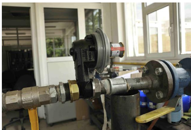
Slika 6a. Regulator tlaka 1. tipa podvrgnut momentu savijanja od 40 Nm
