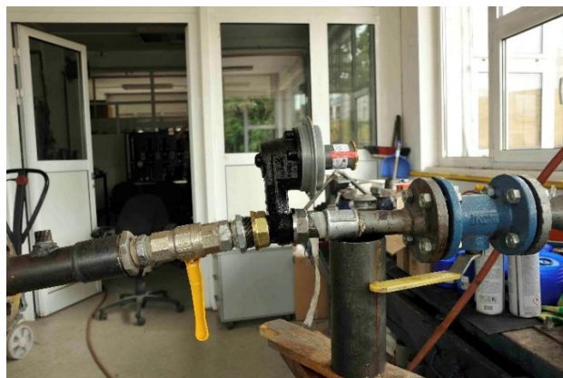
Slika 6b. Regulator tlaka 1. tipa podvrgnut momentu savijanja od 298 Nm
